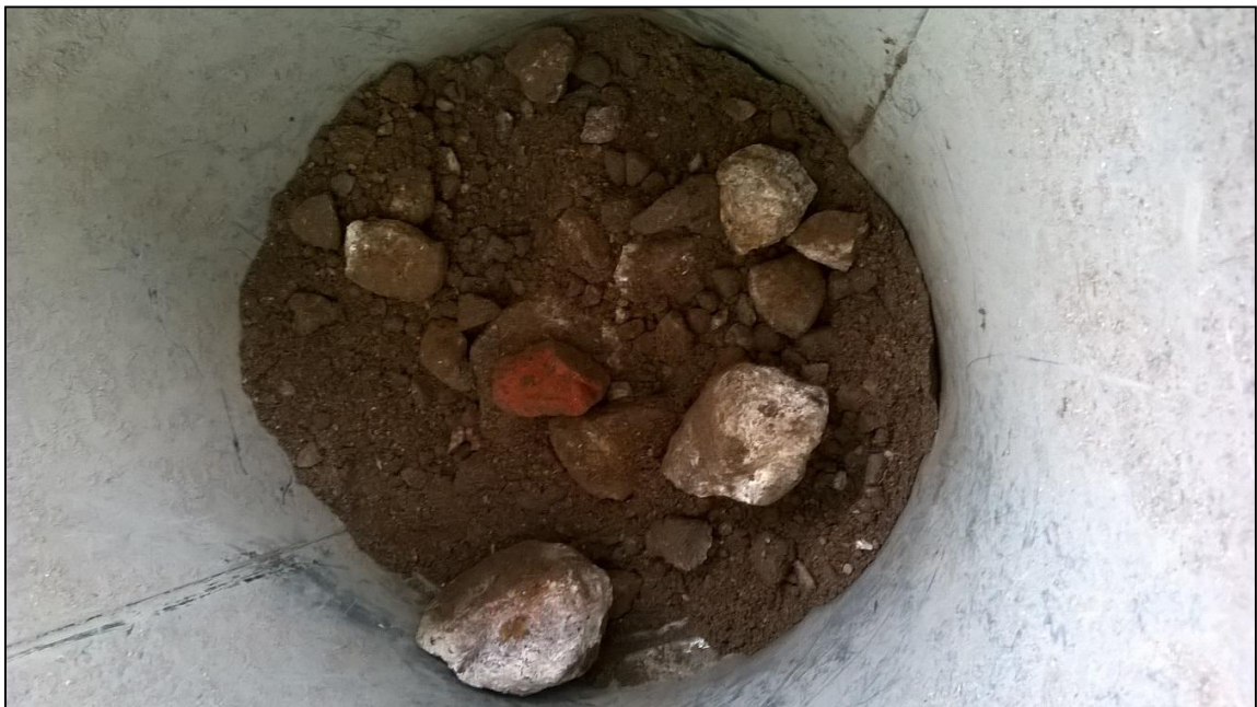
Kuva 5. Tiili- ja betonijätettä tutkimuspisteessä P4.
