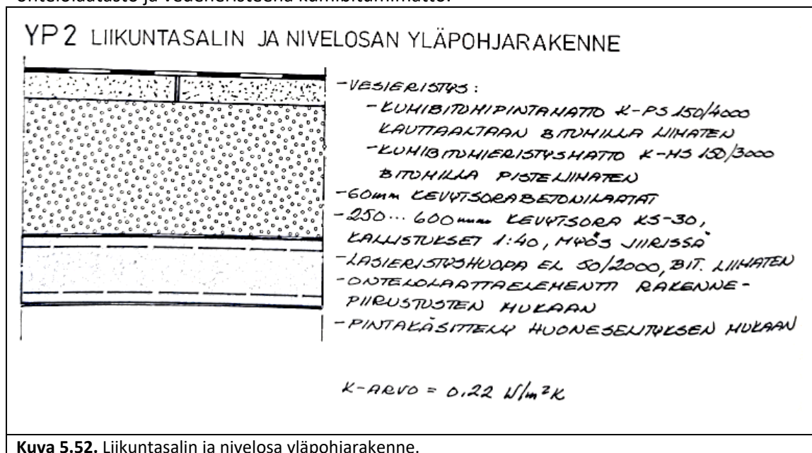
Kuva 5.52. Liikuntasalin ja nivelosa yläpohjarakenne.
