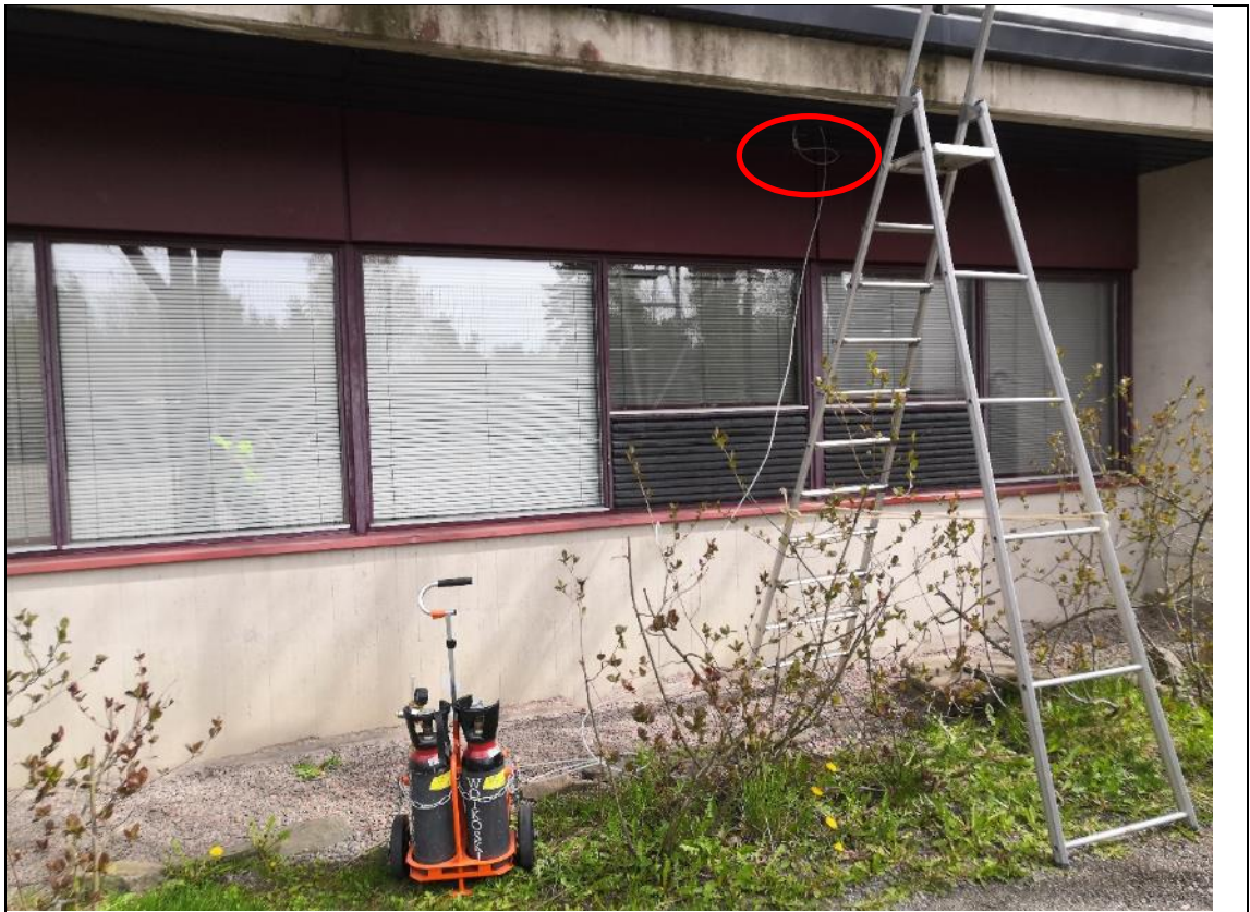
Kuva 5.51. Merkkiaine laskettiin ulkoilmaa vasten olevan välipohjan alle.
