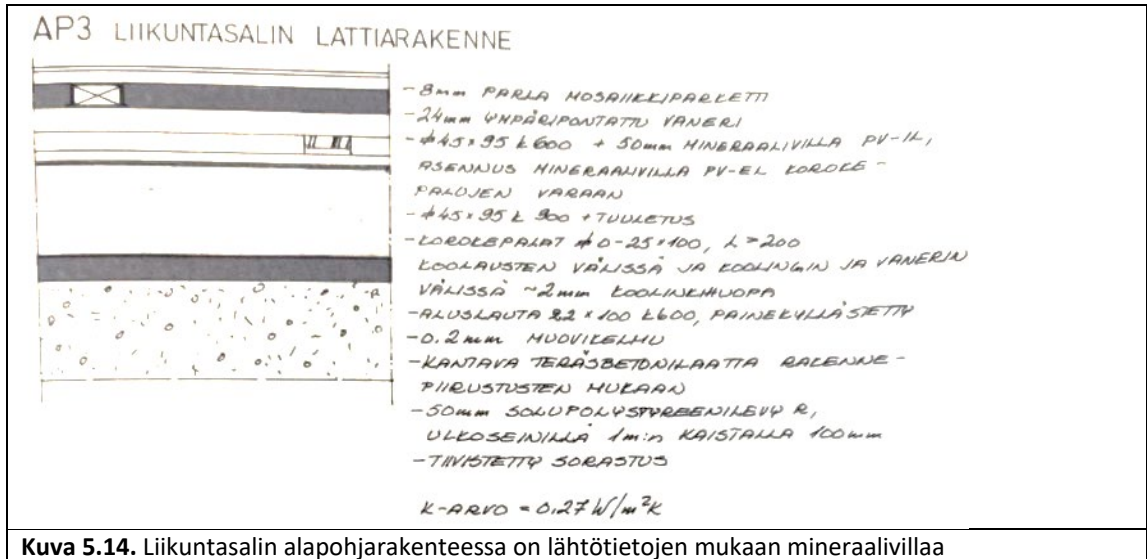
Kuva 5.14. Liikuntasalin alapohjarakenteessa on lähtötietojen mukaan mineraalivillaa
