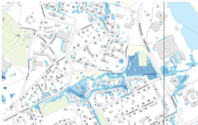
Kuva 3. Kerran 100 vuodessa todennäköisyydellä toistuvan rankkasateen aiheuttama tulvatilanne. Mallinnuksessa ei ole huomioitu hulevesiviemäreitä.
