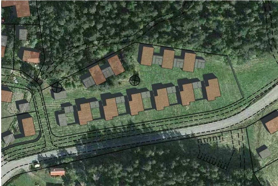
Kuva 15. Säilytettävä puu merkinnällä ⊗.
