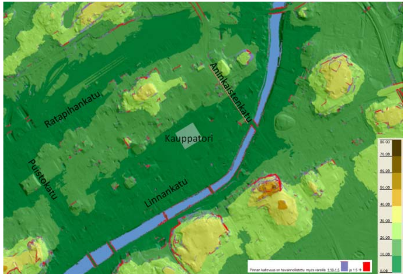
Kuva 21 Rakennettavuuskartta – maanpinnan korkeustaso ja jyrkenteet
