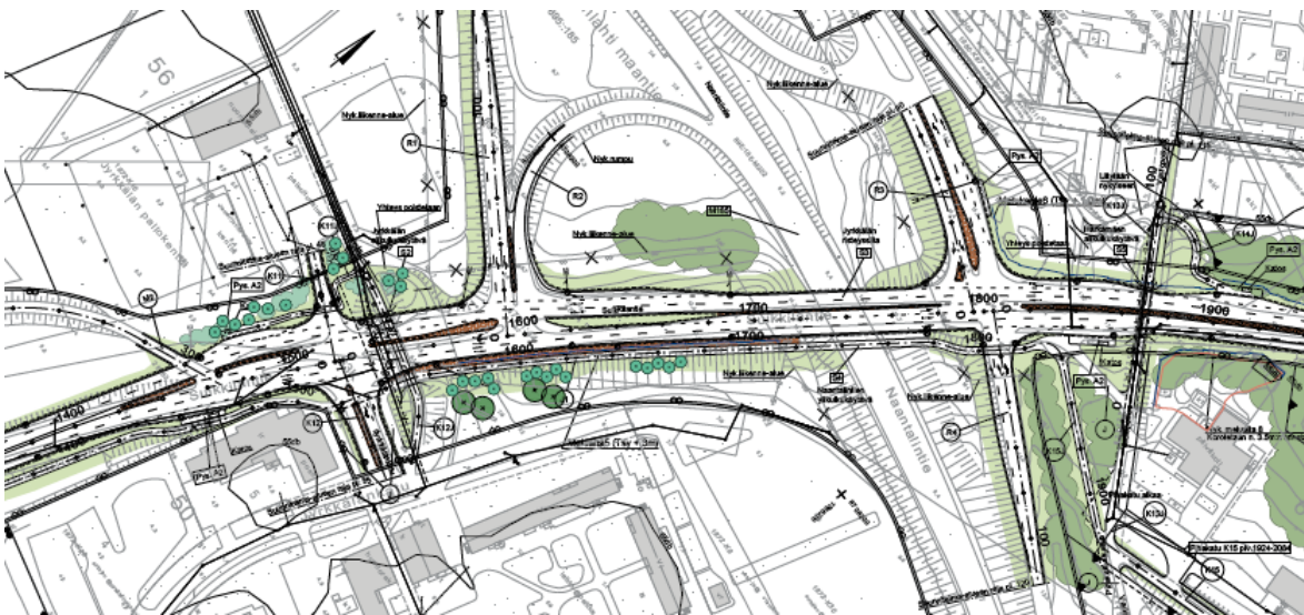
Kuva 22. Tieympäristösuunnitelma, Jyrkkälän ja Naantalintien liittymät (Destia Oy, 2008).
