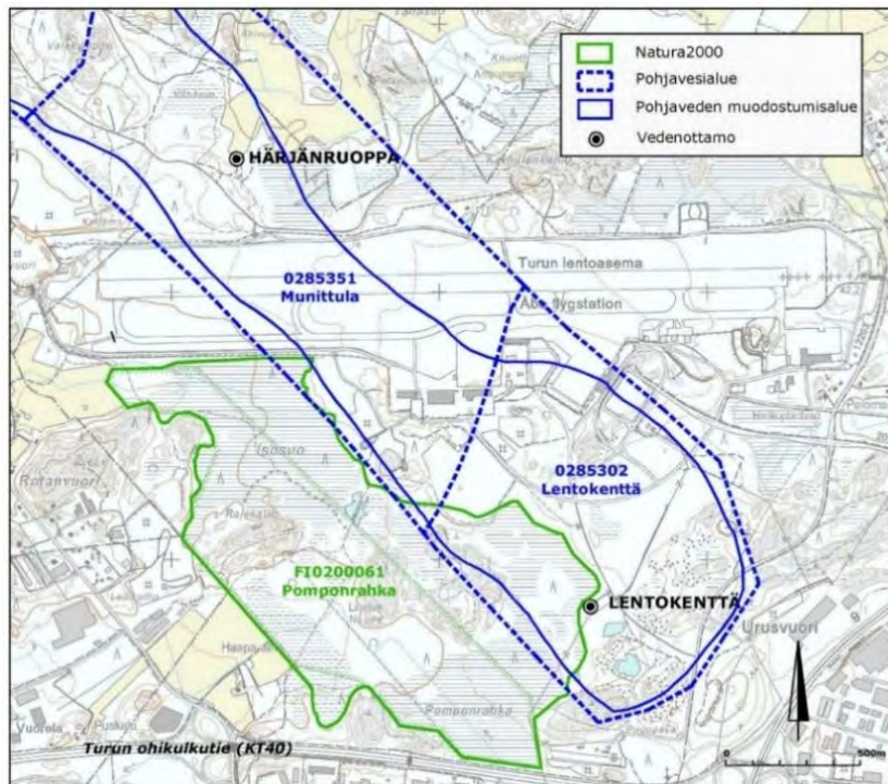
Kuva 2-1 Munittulan ja Lentokentän 2E-luokan pohjavesialueet, jotka sijaitsevat Pomponrahkan itäpuolella olevassa luoteis-kaakko-suuntaisessa harjumuodostumassa.
