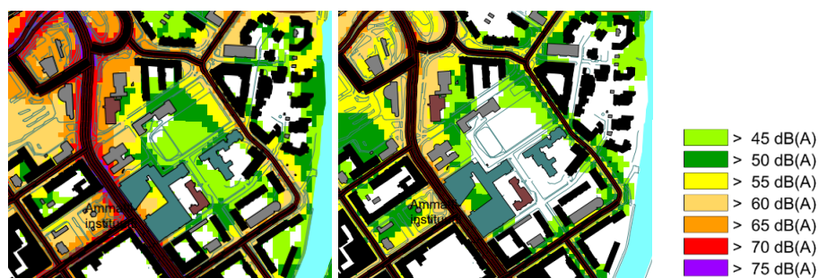
Kuva 4: Tie- ja raideliikenteen aiheuttama päivä- (vas.) ja yöajan (oik.) keskiäänitaso LAeq7-22 nykyinen (9/2017) tilanne Parkinkentän kohdalla. Turun kaupungin meluntorjunnan toimintasuunnitelma 2018-2022.
