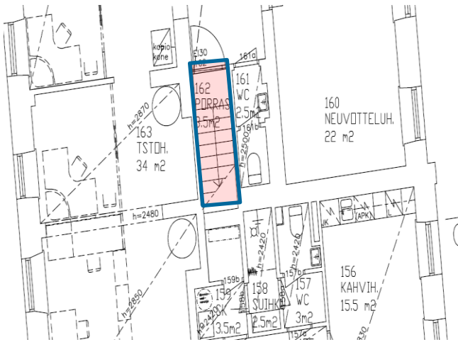
Kuva 55. Portaana alla on umpitila.
