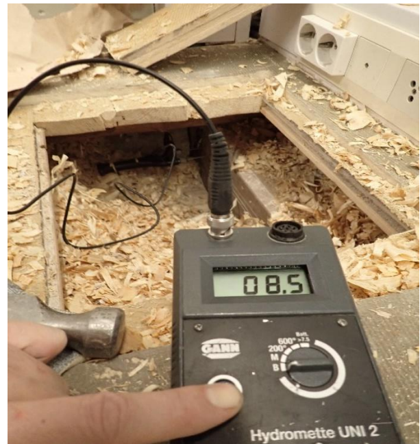
Kuva 34. Kosteusmittaus välipohjan puurakenteesta. Tulos 8.5 p-% on kuiva.
