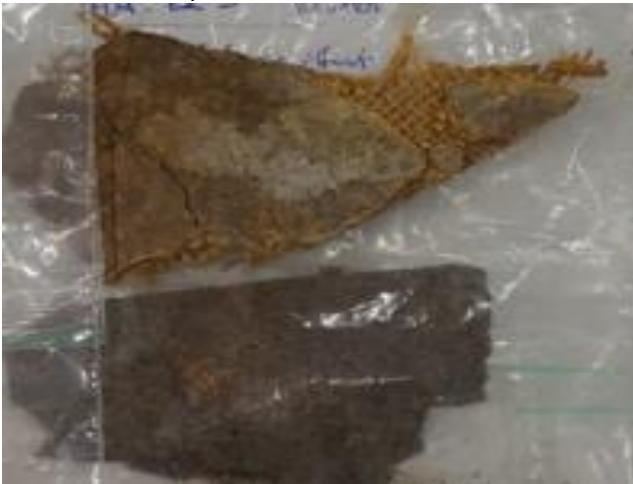
Kuva 4. HA.09 näyte ei sisällä asbestia.
