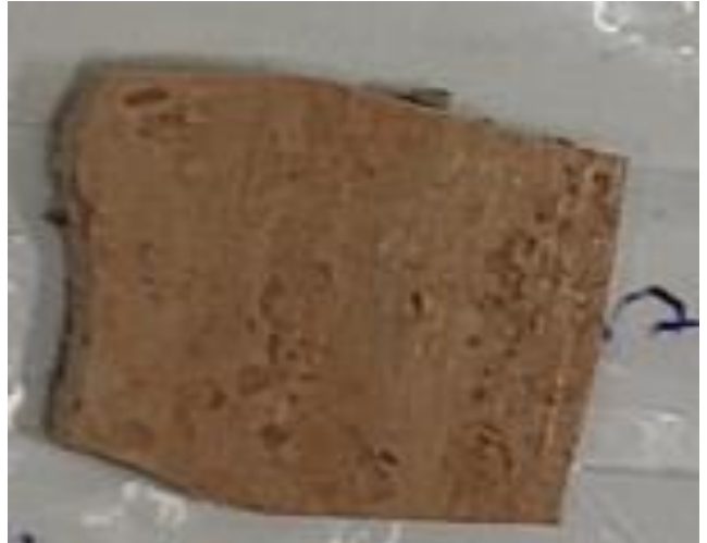
Kuva 11. HA.36 näyte ei sisällä asbestia.
