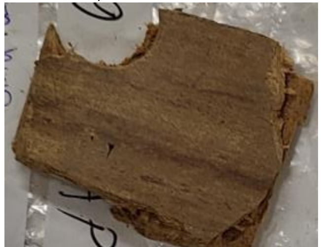
Kuva 7. HA.19 näyte ei sisällä asbestia.
