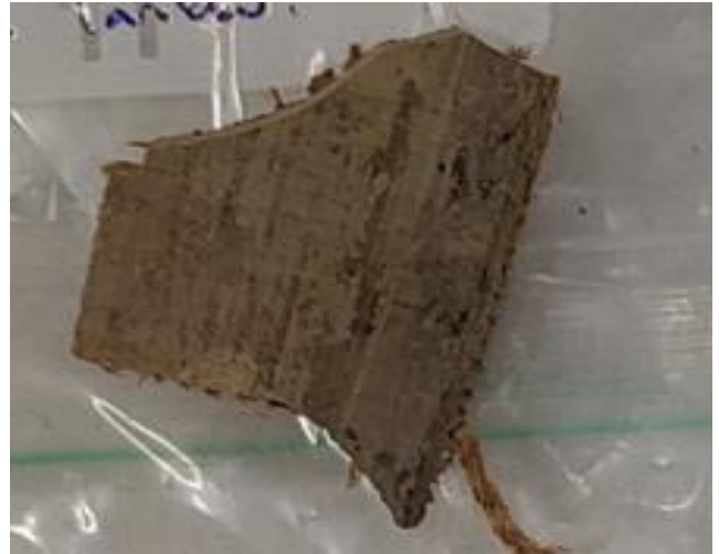
Kuva 3. HA.08 näyte ei sisällä asbestia.
