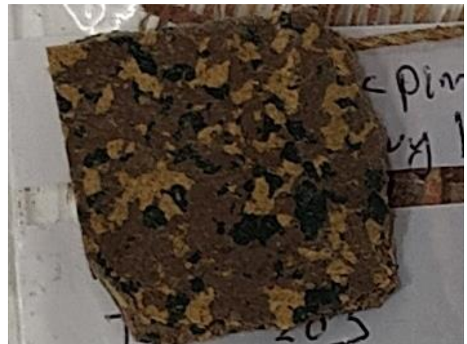
Kuva 2. Vanhan linoleumin kiinnitysliimassa on asbestia (antofylliitti).
