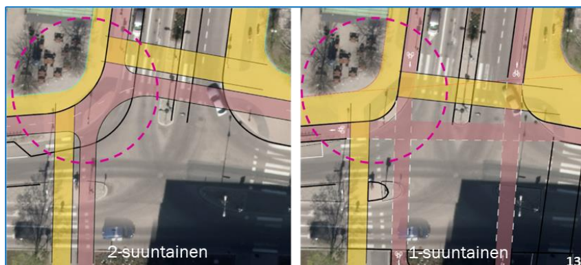
Kuva 4. Esimerkki risteystarkastelusta, jolla havainnollistetaan ajosuuntia ja tilatarvetta.
