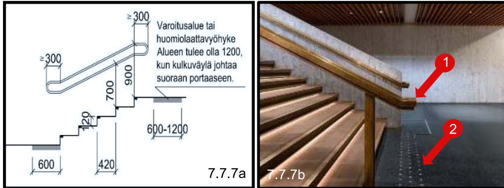
Kuva 7.7.7a Portaiden mittoja: Käsijohteen tulee jatkua vähintään 300 mm portaiden alkamis- ja loppumiskohdan yli. Käsijohde tulee toteuttaa siten, että se on vaakasuorassa alkamis- ja loppumiskohdan ylityksissä. Käsijohteen tulee olla kahdella korkeudella (700 mm ja 900 mm). Varoitusalue tai huomiolaattavyöhyke voidaan toteuttaa esimerkiksi "lattianastoilla". (SuRaKu)
