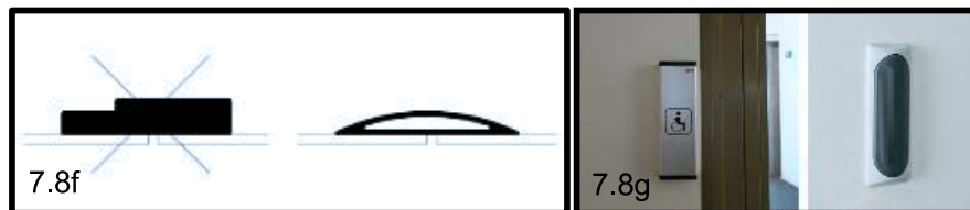
Kuva 7.8f Esimerkki esteettömästä joustavasta kynnyksestä. (Invalidiliitto)
