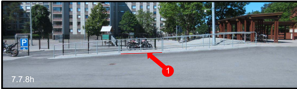
Kuva 7.7.8h Hyvä ratkaisu: [1] Pitkällä luiskalla on välitasanne. Luiskaan tarvitaan välitasanne, jonka kaltevuus on enintään 2 %, kun tasojen korkeusero on yli 500 mm tai luiska on yli 6000 mm pitkä. (Turun normaalkoulu)
