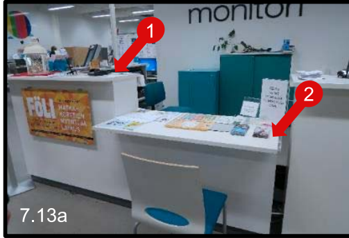
Kuva 7.13a Hyvä ratkaisu: Palvelutiskillä voi asioida sekä [1] seisten että [2] istuen. (Skanssin Monitori)
