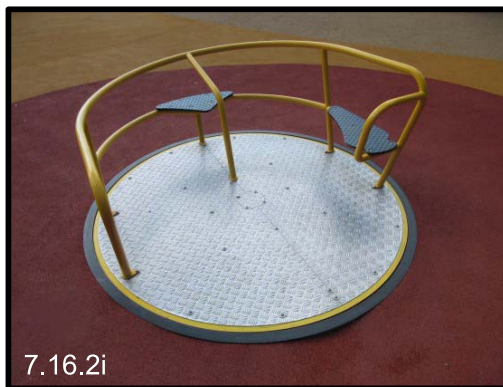
Kuva 7.16.2i Hyvä ratkaisu: Esteettömän karusellin kyytiin pääsee myös pyörätuolilla. (Uittamon esteetön leikkikenttä)
