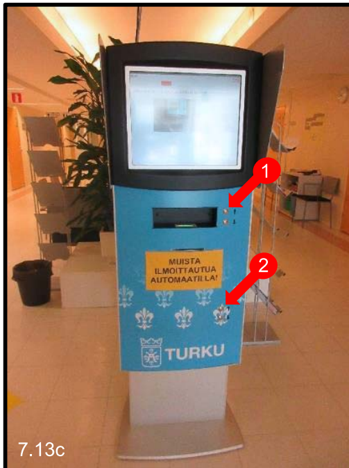
Kuva 7.13c Hyvä ratkaisu: Ilmoittautumisautomaatin korkeus on helposti säädettävissä [1,2] eri korkeuksilla olevista säätöpainikkeista. (Keskushammashoitola)
