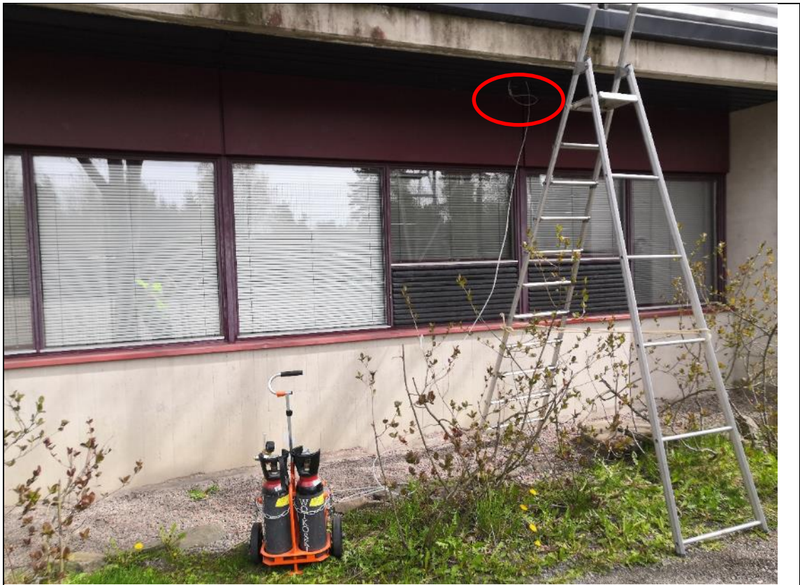
Kuva 5.51. Merkkiaine laskettiin ulkoilmaa vasten olevan välipohjan alle.
