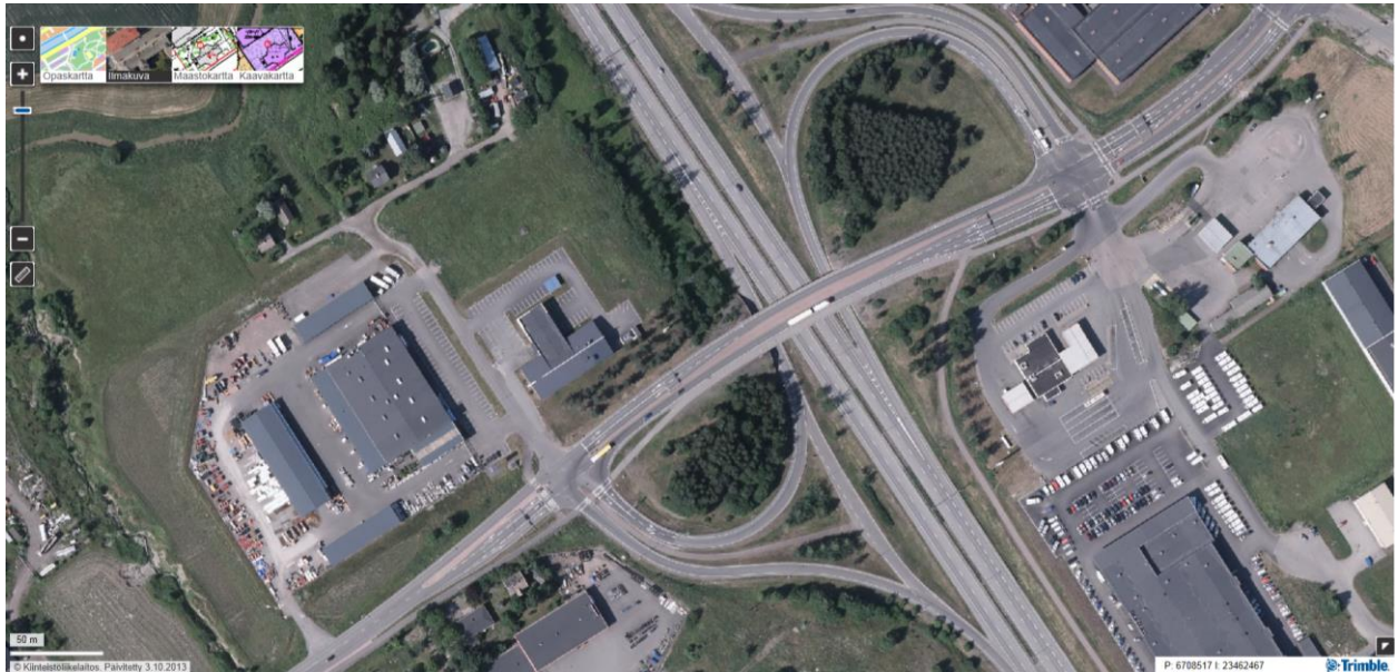
Kuva. Ilmakuva nykytilanteen liikennejärjestelyistä Vanha Tampereentien ja kehätien ramppiliittymissä. Molemmat ramppiliittymät ovat nykytilanteessa valo-ohjattuja.
