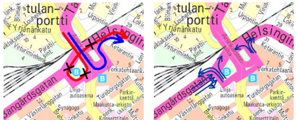
Kuva 32. Matkakeskuksen edellyttämät pääkatujen liikennejärjestelymuutokset radan eteläpuolella.
