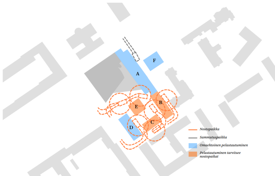
Kuva 25. Suunnitellut pelastusliikenteen nosto- ja sammutuspaikat.
