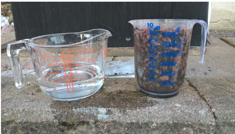
Kuva 2. Materiaalien huokoisuuden vaikutus teholliseen varastointitilavuuteen. Ylimmässä kuvassa vasemmanpuolisessa astiassa on 800 ml vettä. Kun oikeanpuoleinen astia on täytetty 1000 ml saakka vedellä, vasemmanpuoleiseen astiaan on jäänyt jäljelle 400 ml (alin kuva). Kuvatussa esimerkissä käytettyyn litran astialliseen soraan mahtuu siis 400 ml vettä, eli sen tehollinen varastointitilavuus on 40 % astian kokonaistilavuudesta (1000 ml).
