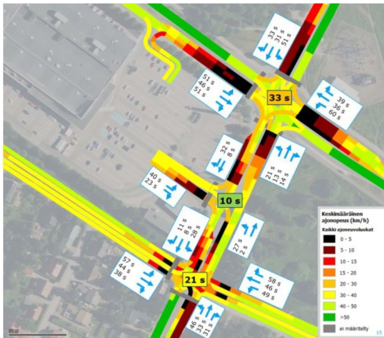
Kuva 44. Liikenteen sujuvuutta kuvaavat simulointien mukaiset keskimääräiset ajonopeudet (vas.) sekä jonopituudet, kun Jaanintien ja Prisman liittymä on valo-ohjattu ja Jaanintie nelikais-taistettu. (Ramboll)
