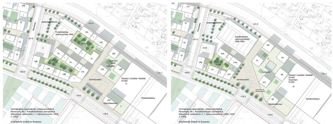
Kuva 22. Luonnosvaiheessa laadittuja vertailevia tarkasteluja Puhallintehtaan eri rakennusvaiheiden säilyttämisestä ja vaikutuksesta alueen uudisrakentamisen määrään ja tehokkuuteen (ei mitataavassa). Kauppakeskukseen liittyvän asuntorakentamisen määrästä ja korkeudesta laadittiin useita vaihtoehtoja. (Arkkitehdit Anttila & Rusanen Oy)
