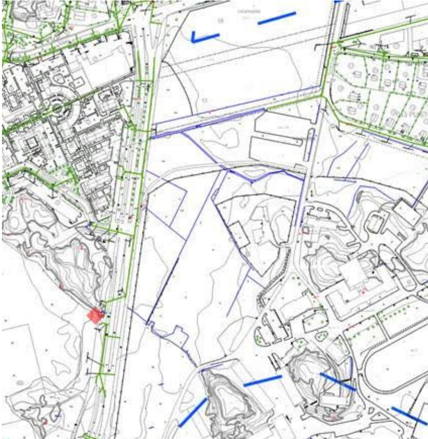
Kuva 11. Suunnittelualueen hulevesiviemärit ja ojat. Idästä tulee alueelle 1800 mm putki. Hirvensalon puistotien alla on vastaavasti 1800 mm putki. Purkupiste merkitty kuvaan punaisella.
