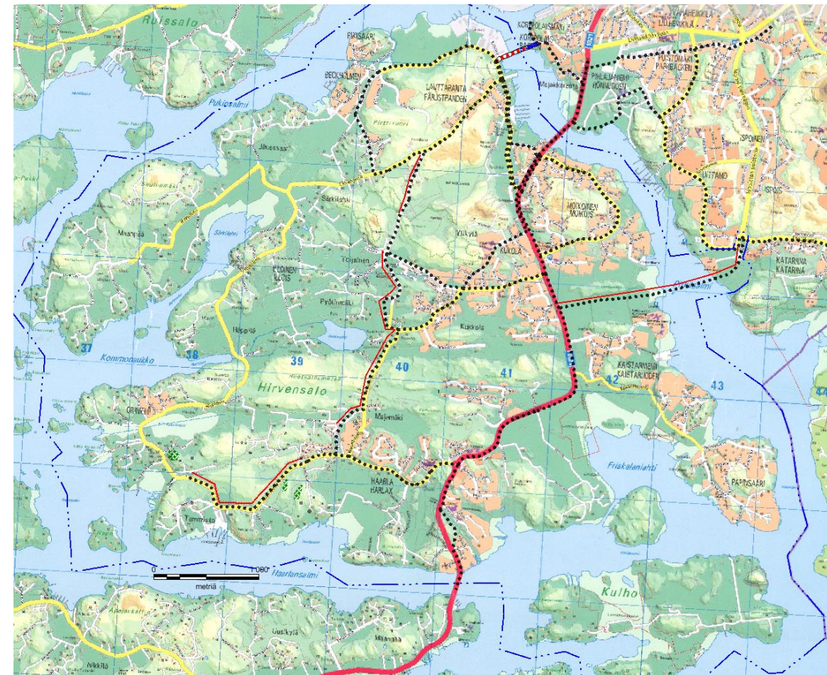
Kuva 59. Pyöräilyn pääreitit. Puuttuvat osuudet punaisella viivalla. Lisäksi varaudutaan pitkällä aikavälillä Häppiläntien ja Maanpäntien pyöräteiden rakentamiseen.
