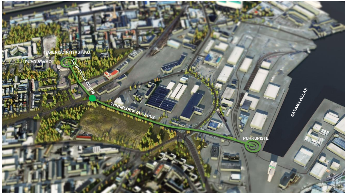
KUVA. Poistoputken reitti puhdistamolta purkupiisteeseen satama-altaaseen.
