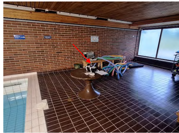
Kuva 213. VOC-näytteenottopumppu oli sijoitettu uima-allastilassa nuolen osoittamaan kohtaan.
