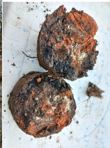
Kuva 2. Tutkimuspiste SW2 ja 0–0,5 m syvyydeltä löytynyttä jätettä.
