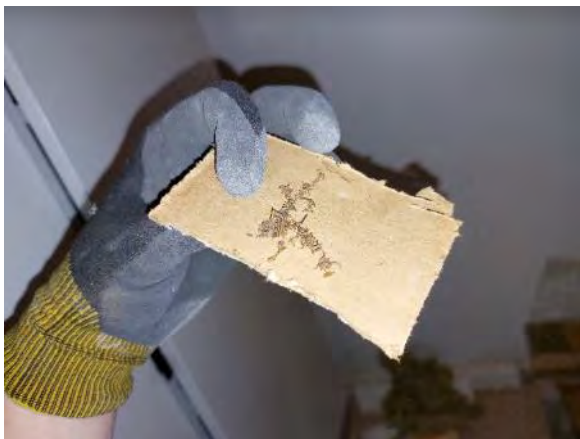
Kuva 136. US 5: Pinkopahvin takana ei ole havaittavissa liimaa.
