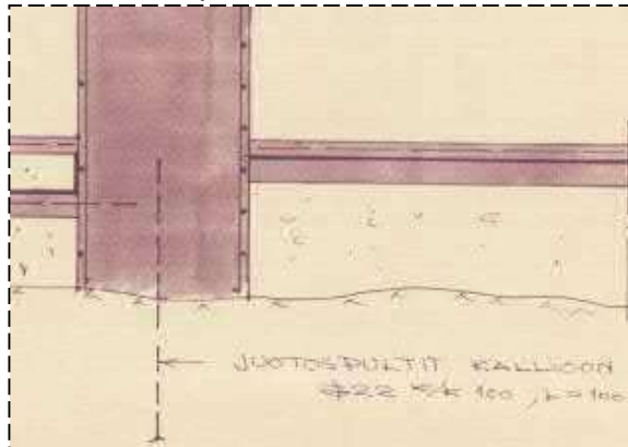
Kuva15. Kallioanturan tyypipiirustus. Kuva on väestönsuojan kohdalta.
