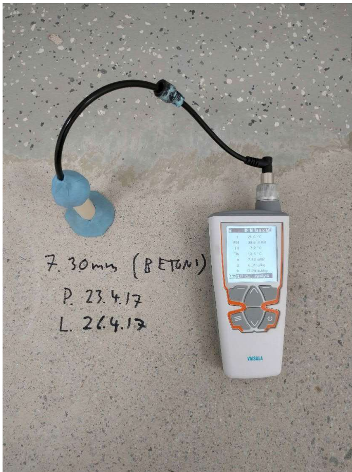
Esimerkkikuva. Porareikämittauksen toteutus.
