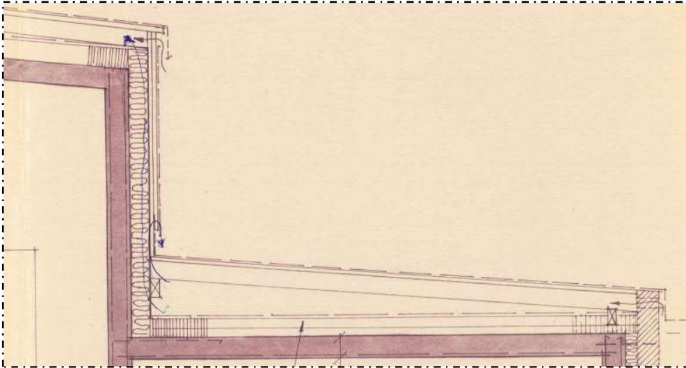
Kuva 112. Yläpohjan tuuletus liikuntasalin alkuperäisen korotusosan kohdalla. Korotusosaan ei ole todennäköisesti lisätty eristettä sillä lisäeristyksellä oltaisiin estetty yläpohjan tuuletus.
