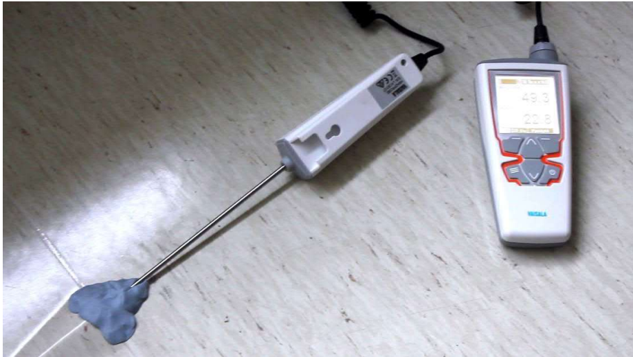
Esimerkkikuva. Viiltokosteusmittauksen toteutus.
