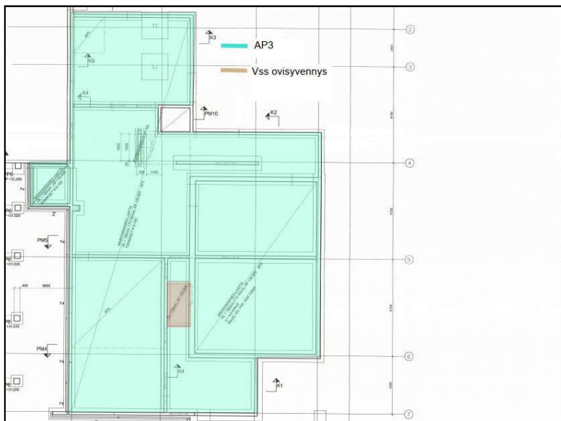
Kuva 143. 1. kerroksen alapohjarakenteiden sijaintikuva.
