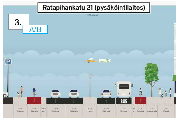
Kuvat 1-3: Ratapihankatu 21-23 poikkileikkaukset pohjoisesta itään päin kuvattuna, eri verkkovaihtoehtoihin (A, B tai C) soveltuvina ratkaisuihin.
