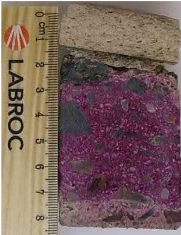
Näytelierrion halkaistu pinta, ulkopinta kuvassa ylöspäin
