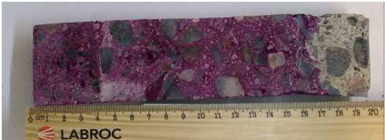
Näytelieriön halkaistu pinta, yläpinta kuvassa vasemmalla
