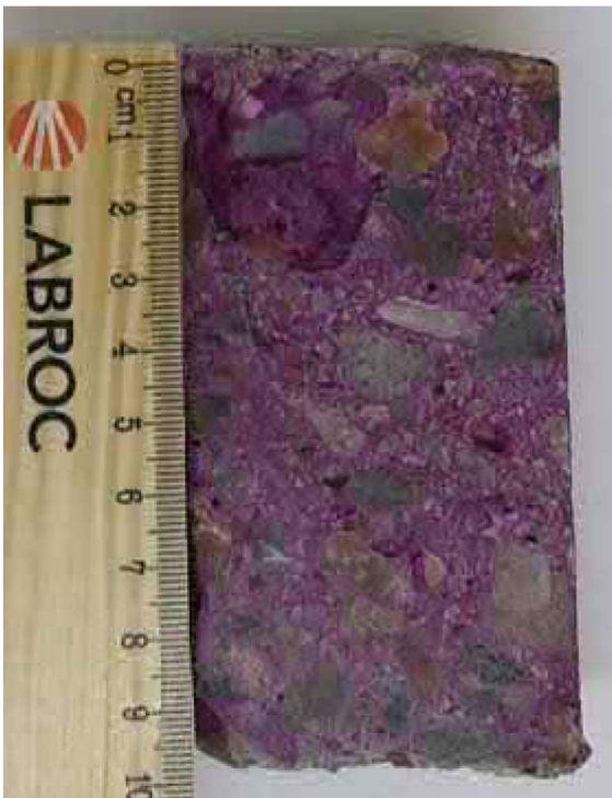
Näytelieriön halkaistu pinta, ulkopinta kuvassa ylöspäin
