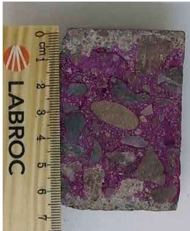
Näyteliieriön halkaistu pinta, ulkopinta kuvassa ylöspäin
