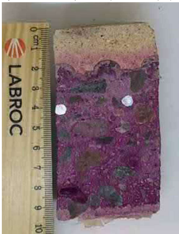
Näytelieriön halkaistu pinta, ulkopinta kuvassa ylöspäin
