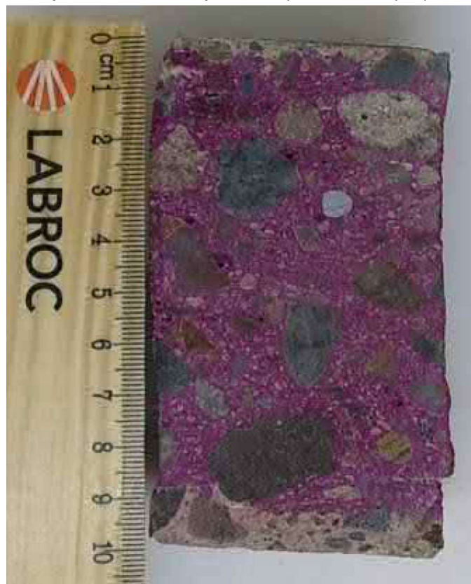
Näytelieriön halkaistu pinta, ulkopinta kuvassa ylöspäin
