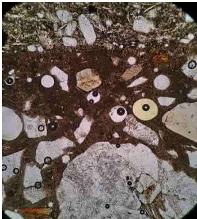
Ohuthiekuva, kuvan vaakasisivun pituus on 1 mm
