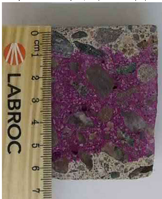
Näytelieriön halkaistu pinta, ulkopinta kuvassa ylöspäin
