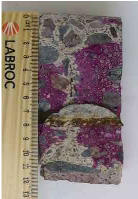
Näytelieriön halkaistu pinta, ulkopinta kuvassa ylöspäin
