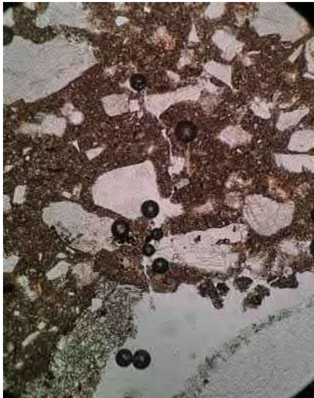
Ohuthiekuva, kuvan vaakasivun pituus on 1,5 mm
