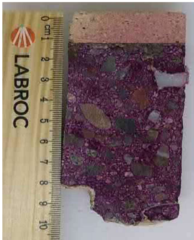
Näytelieriön halkaistu pinta, ulkopinta kuvassa ylöspäin
