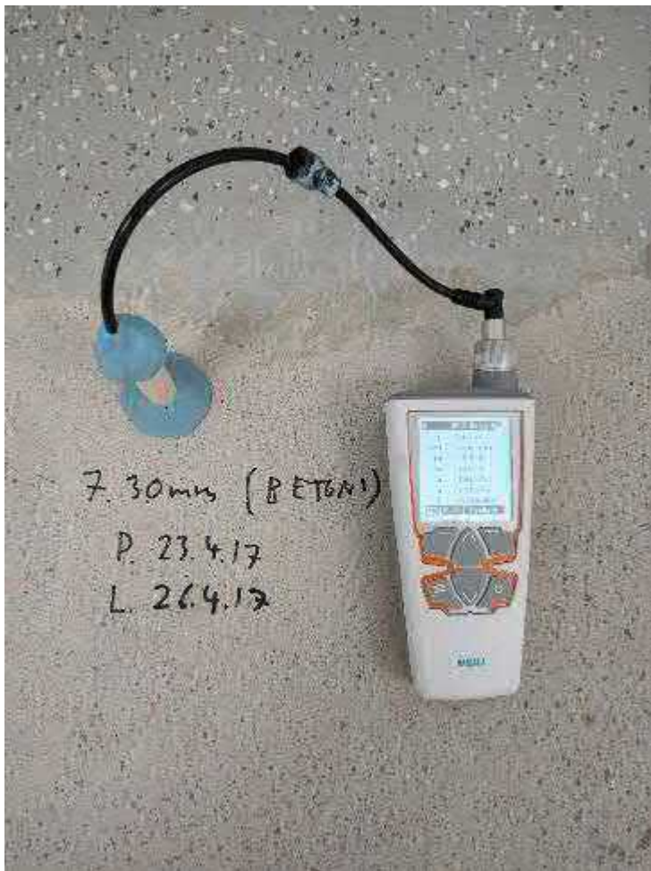
Esimerkkikuva. Porareikämittauksen toteutus.
