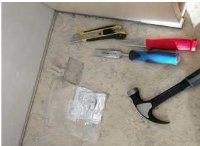
Esimerkkikuva. VOC-BULK-näytteenotto lattiapäällysteestä (FCG Oy).
