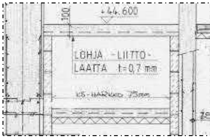
Kuva 59. Rakennekuva alapohjakanaalista, joka sijaitsee keittiön takana käytävällä.
