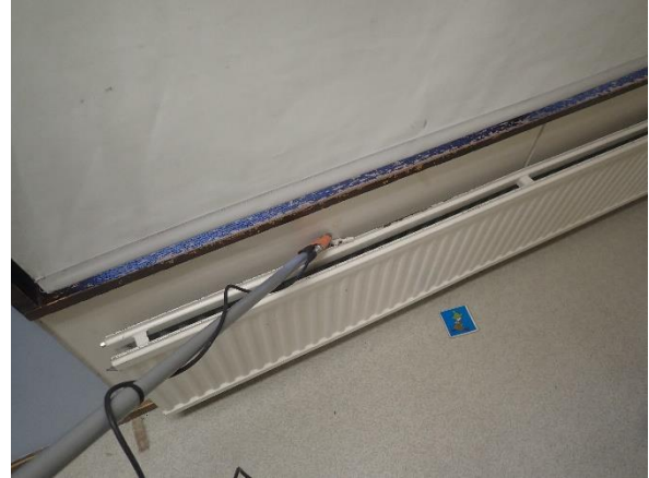
Kuva 94. MAK2: Patterikiinnikkeiden kohdasta havaittiin pistemäistä ilmvuotoa.
