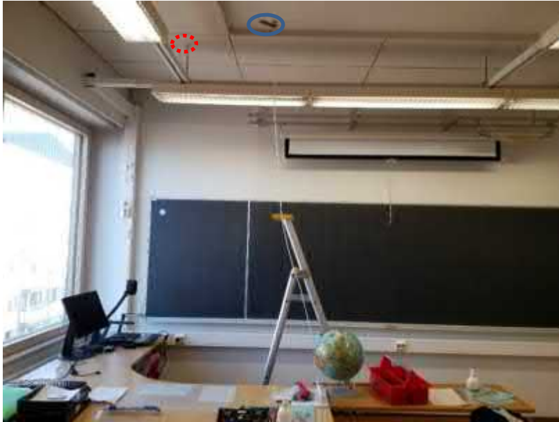
Kuva 6.3.4. Yläpohjan merkkiainekoe tilassa 311. Mittauksessa todettiin ainoastaan yksi pistemäinen ilmavuoto valaisimen kiinnikkeen läpiviennistä (punainen ympyrä). Merkkiaineen laskupaikka on merkattu sinisellä ympyrällä.
