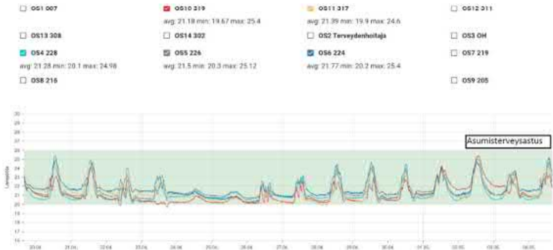
Kuva 7.4.2. Lämpötilaseuranta 19.4.-4.5.2021 TK6 palvelualueen tiloissa 224, 226, 228, 317, 319. Lämpötilat ovat mittausjakson aikana tavoitetasolla. Tavoitetaso (20...26 °C) on esitetty vihreällä alueella.
