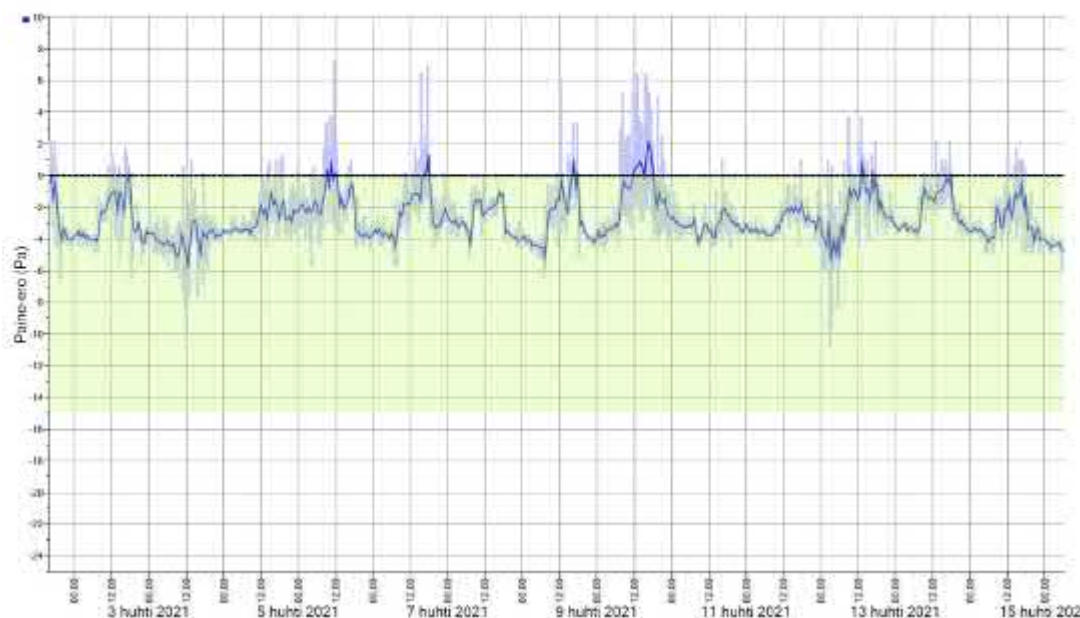
Kuva 7.2.1. Paine-eroseuranta 1.-15.4.2021 ensimmäisen kerroksen tilassa 175. Tila on tavoitteen mukaisesti pääosin lievästi alipaineinen ulkoilmaan (n. 2 Pa). Tavoitetaso (0...-15 Pa) on esitetty vihreällä alueella.
