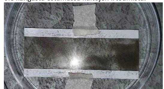
Kuva 4.5.13. Kuitunäytteen KT1 kuitupitoisuutta ei kyetty laskemaan pölyisyyden vuoksi (kuituja kuitenkin havaittiin)
