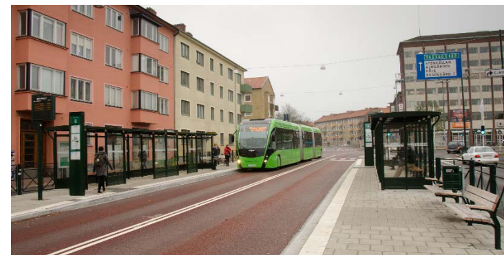
Bild 7. Superbussarnas hållplatser finns vanligtvis mitt på gatan och det finns inga hållplatsfördjupningar. På bilden en superbuss i Malmö.
