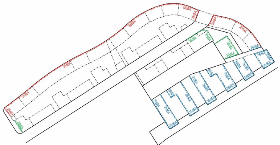
Kuva 51. Kaavaehdotuksen julkisivujen ääneneristävyysvaatimukset.
