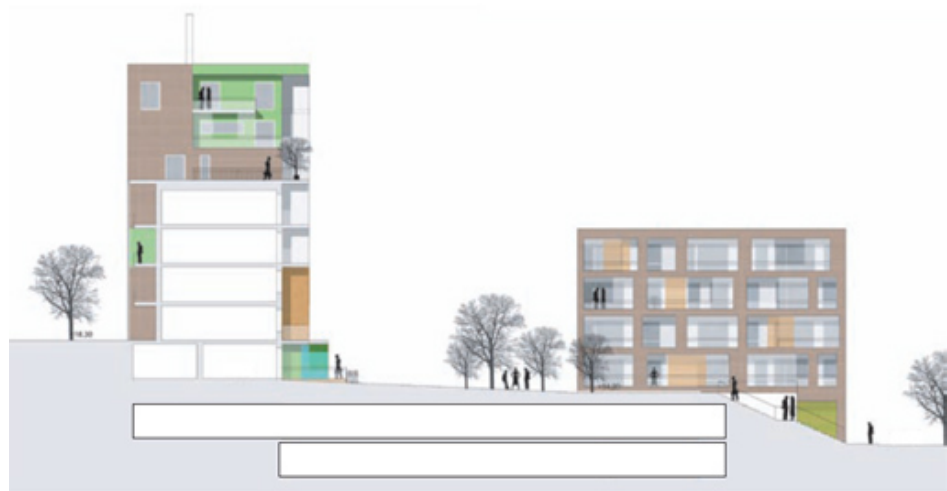
Kuva 47. Korttelileikkaus Lättähatunpolun kohdalta (Arkkitehdit NRT Oy, 2007). Asuinkortteli sijoittuu Köydenpunojankadun (kuvassa vasemmalla) ja Veturikadun (kuvassa oikealla) väliin siten, että rakennusten välinen piha on Veturikatua ylempänä, mutta Köydenpunojankatua alempana.
