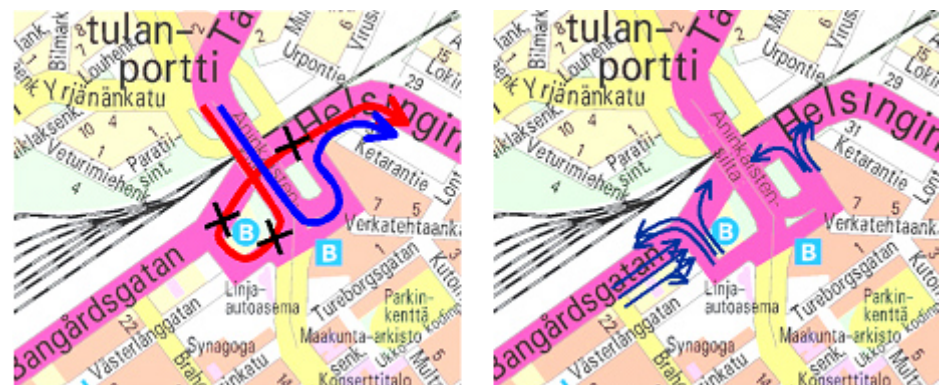
Kuva 31. Matkakeskuksen edellyttämät pääkatujen liikennejärjestelymuutokset radan eteläpuolella.
