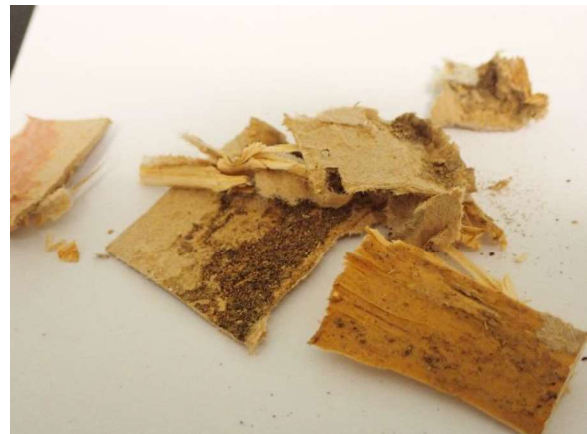
Kuva 21. Hirsiseinää vasten olevan vanhan tapetin liisteri ei sisällä asbestia.
