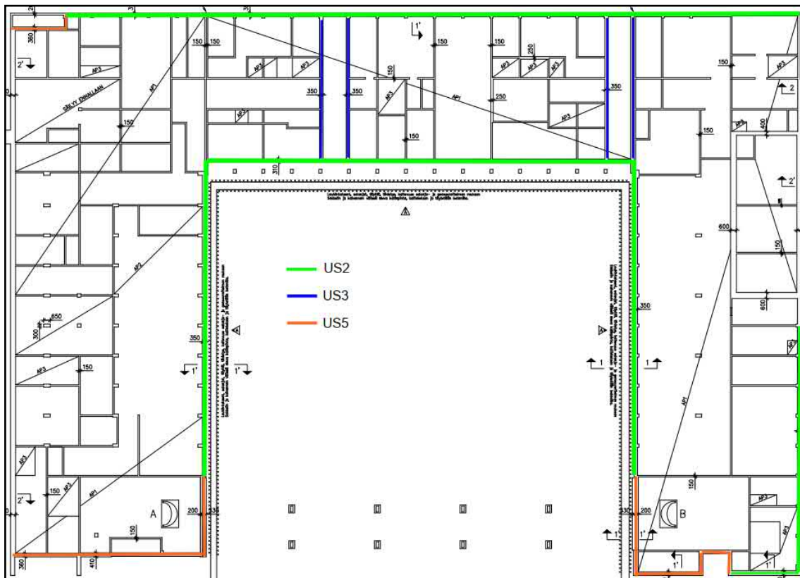
Kuva54. 1. kerroksen ulkoseinärakenteet on merkattu kuvaareivär
