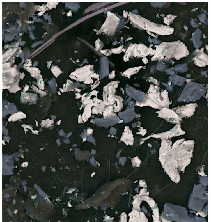
Esimerkkikuva. Vasemmalla pölynäytteenotto ilmanvaihtokanavasta (FCG Oy). Oikealla näytteen koostumuksen analyysi elektronimikroskoopilla (Mikrofokus Oy).
