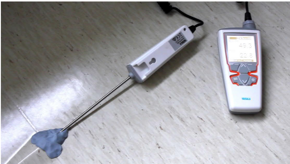
Esimerkkikuva. Viiltokosteusmittauksen toteutus.
