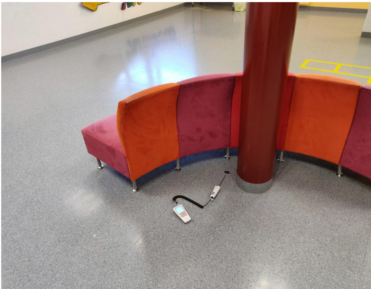
Kuva 160. Välipohjissa käytetyn pinnoitteen kosteusteknistä toimintaa tarkasteltiin pistokoeluontoisten viiltoimittusten avulla. Mittauksissa ei havaittu pinnoitteen vaurioitumisen kannalta kriittisiä arvoja.
