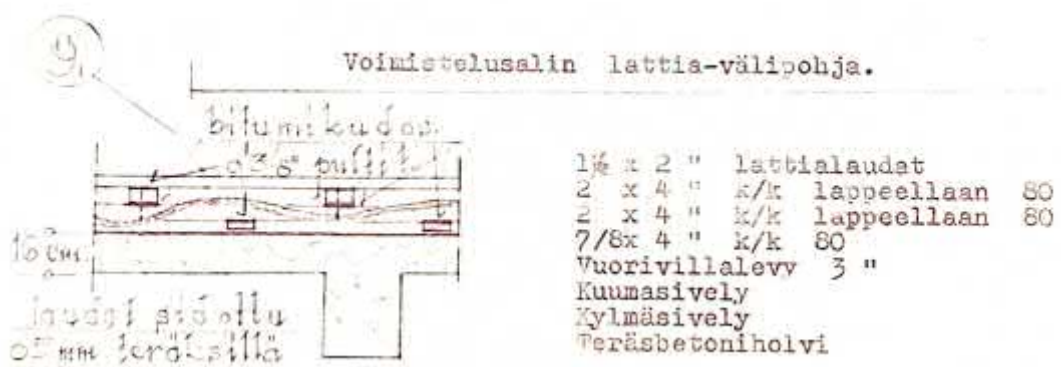
Kuva 6.4.3. Liikuntasalin lattian välipohjarakenne
