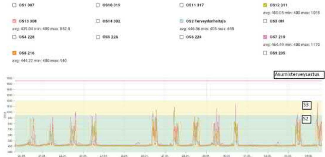
Kuva 7.4.1. Hiilidioksidipitoisuus 19.4.-4.5.2021 TK5 palvelualueen tiloissa Terveystoimisto, 216, 219, 308. Pitoisuudet olivat sisäilmastoluokassa S2-S3. Sisäilmastoluokka S2 on esitetty vihreällä alueella ja S3 keltaisella alueella. Asumisterveysasetuksen toimenpideraja on esitetty punaisella katkoviivalla.
