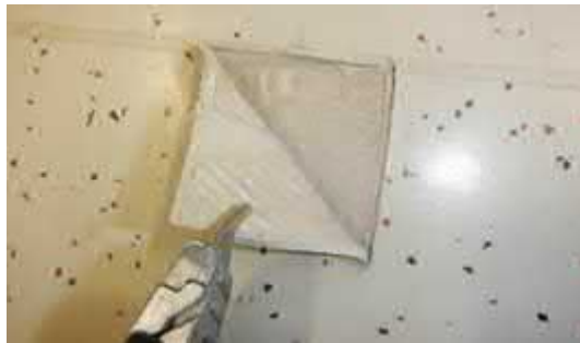
Kuva 5.2.6. Viiltomittauspiste V2, ei poikkeavaa maton liimakerroksessa.
