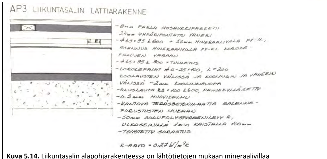
Kuva 5.14. Liikuntasalin alapohjarakenteessa on lähtötietojen mukaan mineraalivillaa
