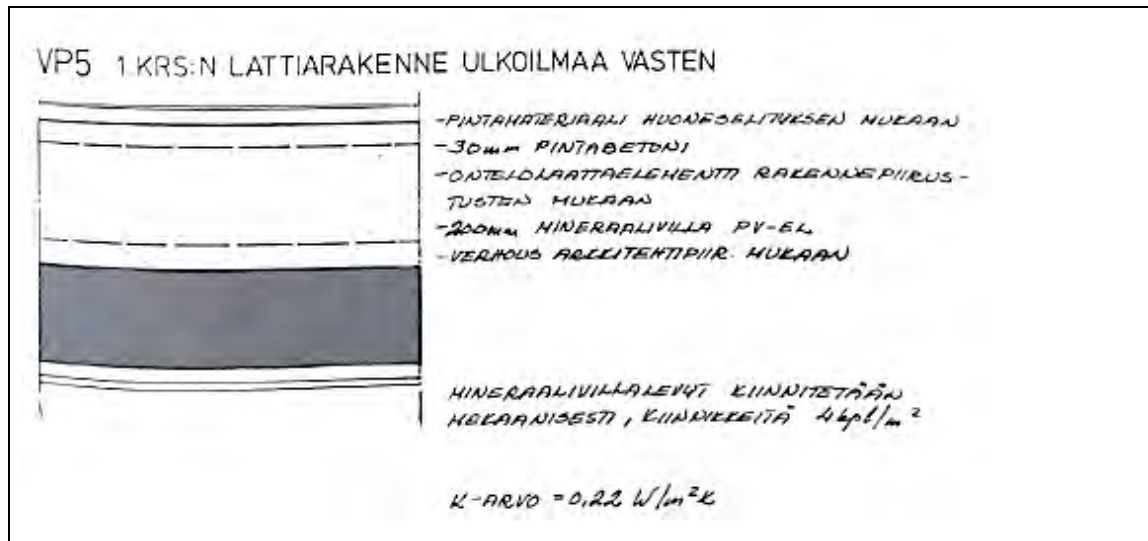
Kuva 5.49. Ulkoilmaa vasten oleva lattiarakenne.
