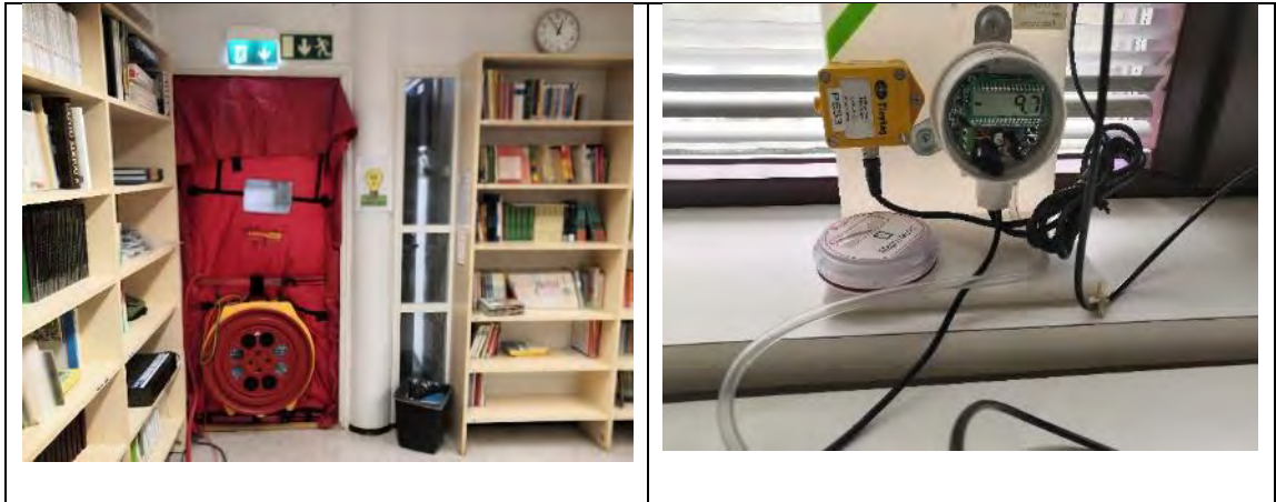
Kuva 5.40. Tilat alipaineistettiin n. -10 Pa, merkkiainetutkimusten ajaksi.
