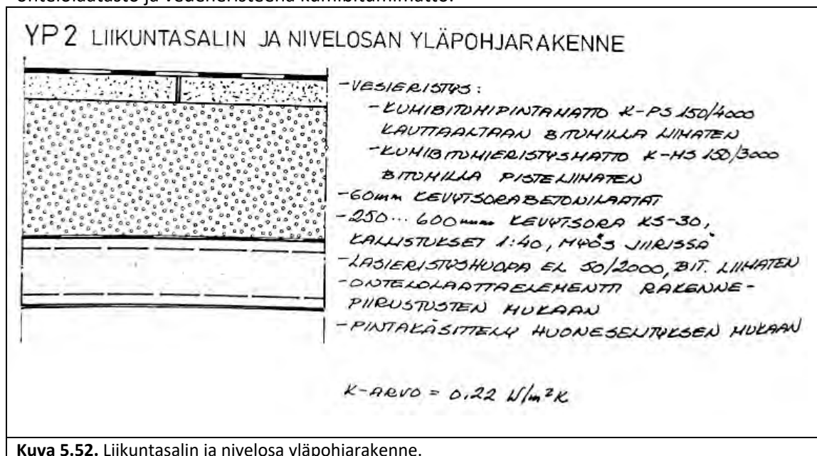
Kuva 5.52. Liikuntasalin ja nivelosa yläpohjarakenne.
