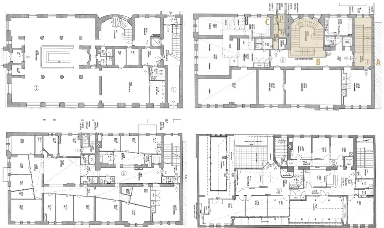
Schauman arkitehtien laatimat muutoskuvat 2008 (RakVa). Ylhäällä vasemmalla ensimmäinen kerros, ylhäällä oikealla toinen kerros, johon on merkitty porrashuoneet, alhaalla vasemmalla kolmas kerros ja alhaalla oikealla ul-lakkokerros.
