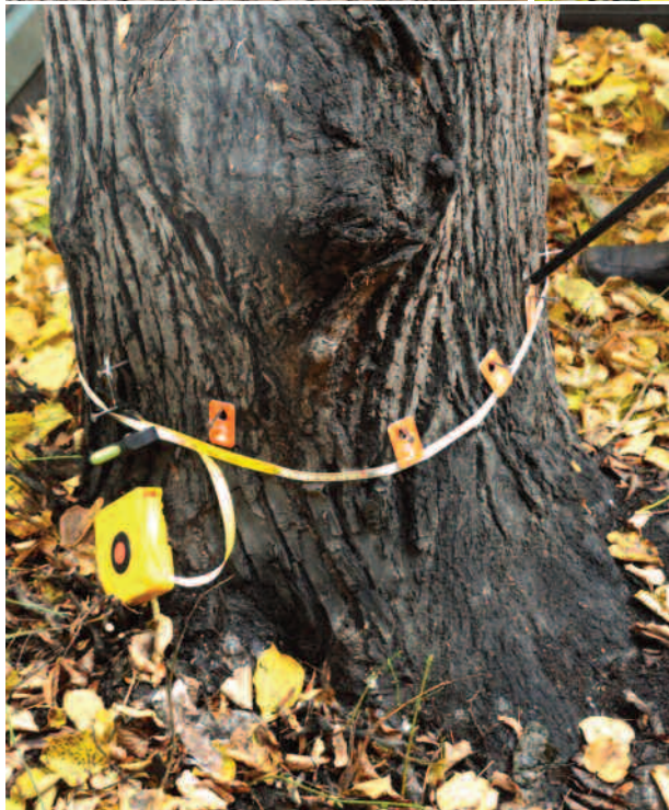
Poistettu iso oksa, kasvanut umpeen, haavapuun alla lahoa
