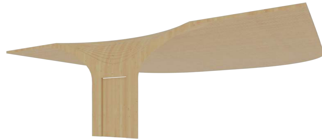
Leikkaus B CNC-jyrsitty CLT levy
