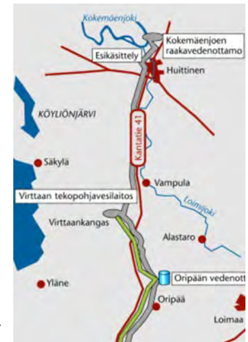
Kuva 197. Tekopohjavesijärjestelmä (Turun Seudun Vesi Oy 2012).
